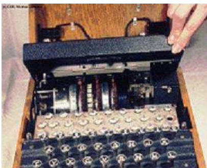
La máquina Enigma, utilizada para cifrar por los alemanes en la Segunda Guerra Mundial
